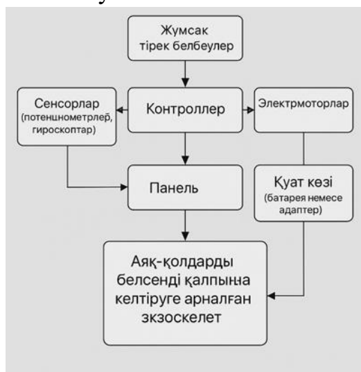
2.2-сурет – Құрылғының функционалдық блок-схемасы
